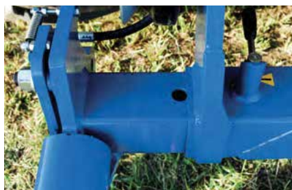
Mehaaniline laiuse reguleerimine 50mm haaval.
