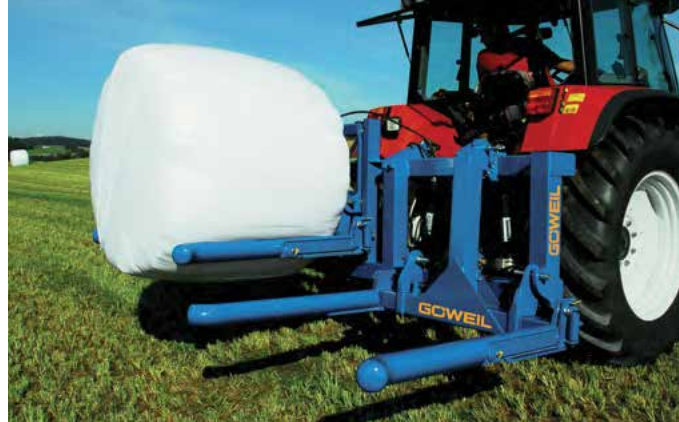
2. Lisahüdraulika tõstab esimese rulli kuni 380mm kõrgusele
