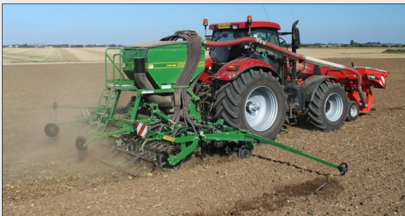
ADS seemnete dosaator ja jaotusmehhanism. Punkri mahutavus varieerub sõltuvalt mudelist vahemikus 1000 kuni 3000 liitrit.
